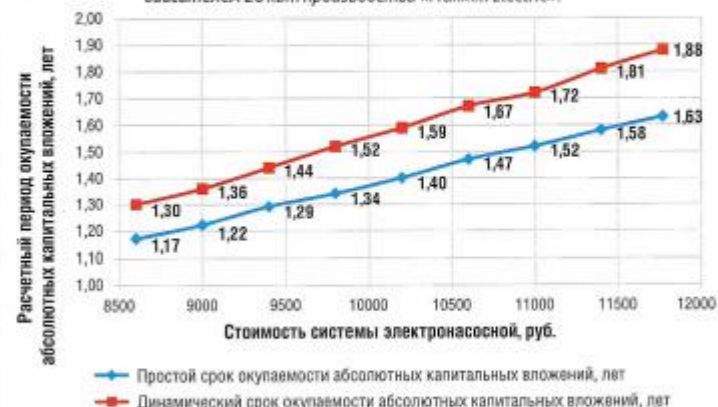
Рис. 2. График окупаемости абсолютных капитальных вложений применения СВ-6 в комплекте с насосом СПА 8-80-90нр, синхронным приводом на постоянных магнитах мощностью 26 кВт производства ОАО «Завод Промбурвод» и частотным преобразователем в сравнении с базовым агрегатом СПА 8-80-90нр с асинхронным двигателем 26 кВт производства «Franklin Electric».
